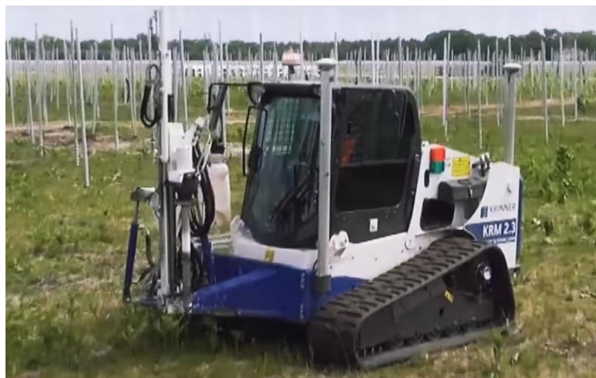
Fig. 15 Esempio di fissaggio delle strutture di supporto
