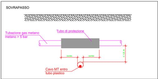
Qualora non sia possibile osservare tale distanza, la tubazione del gas deve essere collocata entro un tubo di protezione il quale deve essere prolungato da una parte e dall'altra dell'incrocio per almeno 1 m quando sovrappassa la canalizzazione MT BT e 3 m quando la sottopassa; le distanze vanno misurate a partire dalle tangenti verticali alle pareti esterne della canalizzazione in ogni caso deve essere evitato il contatto metallico tra le superfici affiancate.
