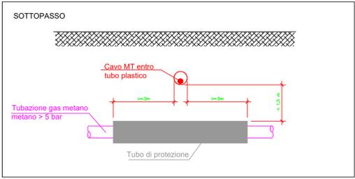
Nei parallelesimi tra cavidotti MT o BT e tubazioni del gas metano non drenate a pressione nominale > 5 bar, la distanza minima tra le due superfici affiancate non deve essere inferiore alla profondità di interramento della condotta del gas, salvo l'impiego di diaframmi continui di separazione.
