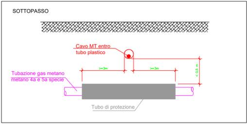
Nei casi di percorsi paralleli tra i cavidotti MT BT e tubazioni del gas metano a pressione nominale < 5 bar, la distanza misurata fra le due superfici affiancate deve essere:
