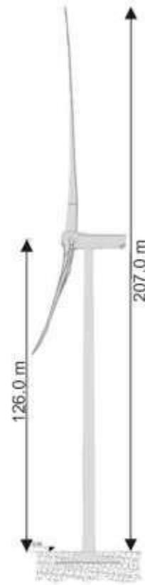
VISTA LATERALE AEROGENERATORE E TORRE EOLICA TIPO_Scala 1:500
