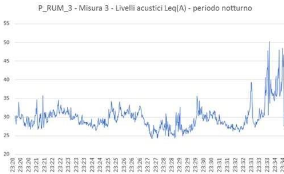
Figura 3-39 Punto di misura P_RUM_3: misura 3 (periodo notturno)
