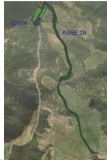
Nello specifico, nella progettazione della viabilità di accesso agli aerogeneratori, si è tenuto conto del tipo di automezzi necessari al trasporto dei componenti che necessitano di raggi di curvatura minimi di 50 metri (laddove non possibile risulta necessario l'allargamento della piattaforma stradale), livellette con pendenza massima pari al 14%, sia in salita che in
