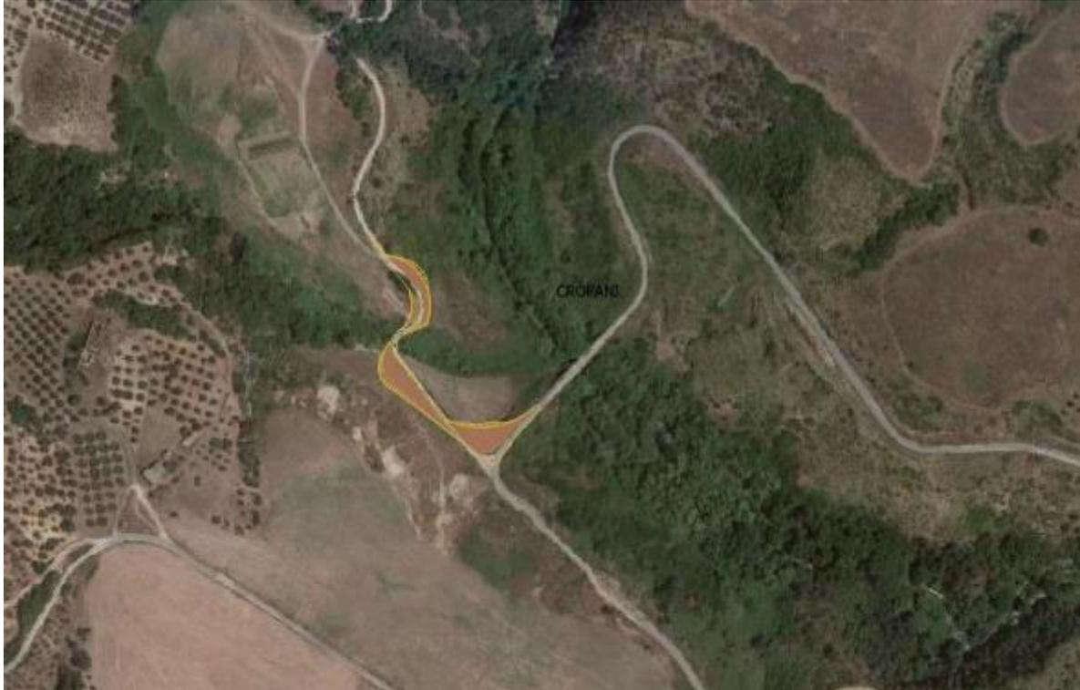
**Asse 5 e Asse 6:** Si tratta di due piccoli interventi di nuova realizzazione di circa 160 metri ciascuno che partendo dalla zona dell'Asse 4\_ALL summenzionato, si raccordano con il successivo Asse 7\_AD in avvicinamento all'aerogeneratore CR04.
