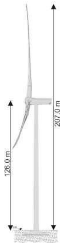
VISTA LATERALE AEROGENERATORE E TORRE EOLICA TIPO_Scala 1:500
