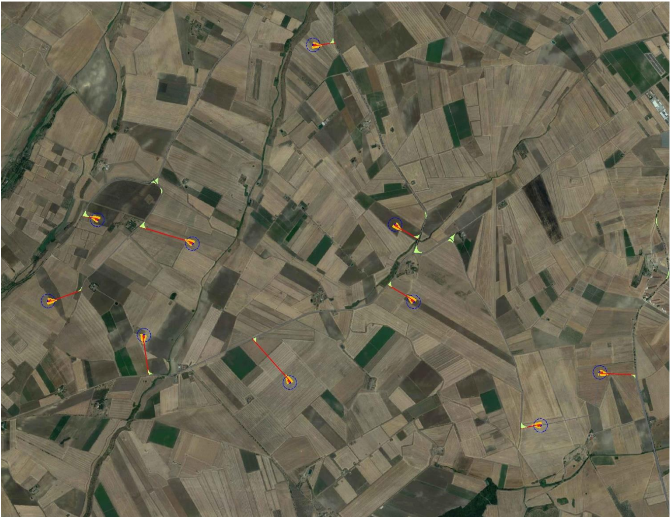
Area di impianto su ortofoto - in rosso la viabilità di nuova realizzazione per l'accesso alle torri
