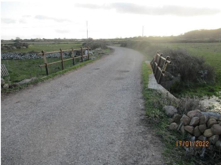
**Punto X2** – Ponticello sul Rio Mene, da attraversare sotto alveo, previa posa di contro tubo con talpa teleguidata.
