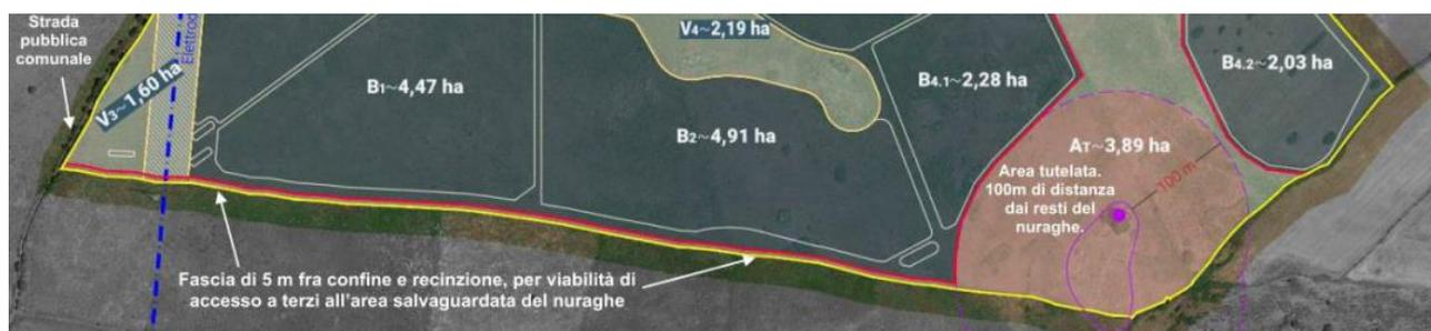
Di seguito l'assetto della centrale FV; a ciascun colore corrisponde un campo FV indipendente, collegato ad un proprio inverter (inverter centralizzati Outdoor).
