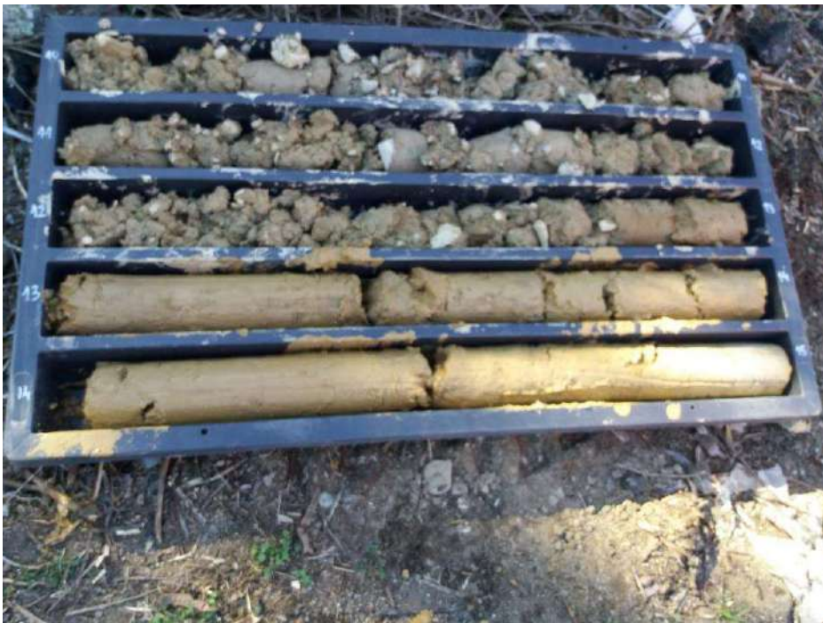
Cassette con campioni carotati località Savonesa. (carotaggio continuo)
