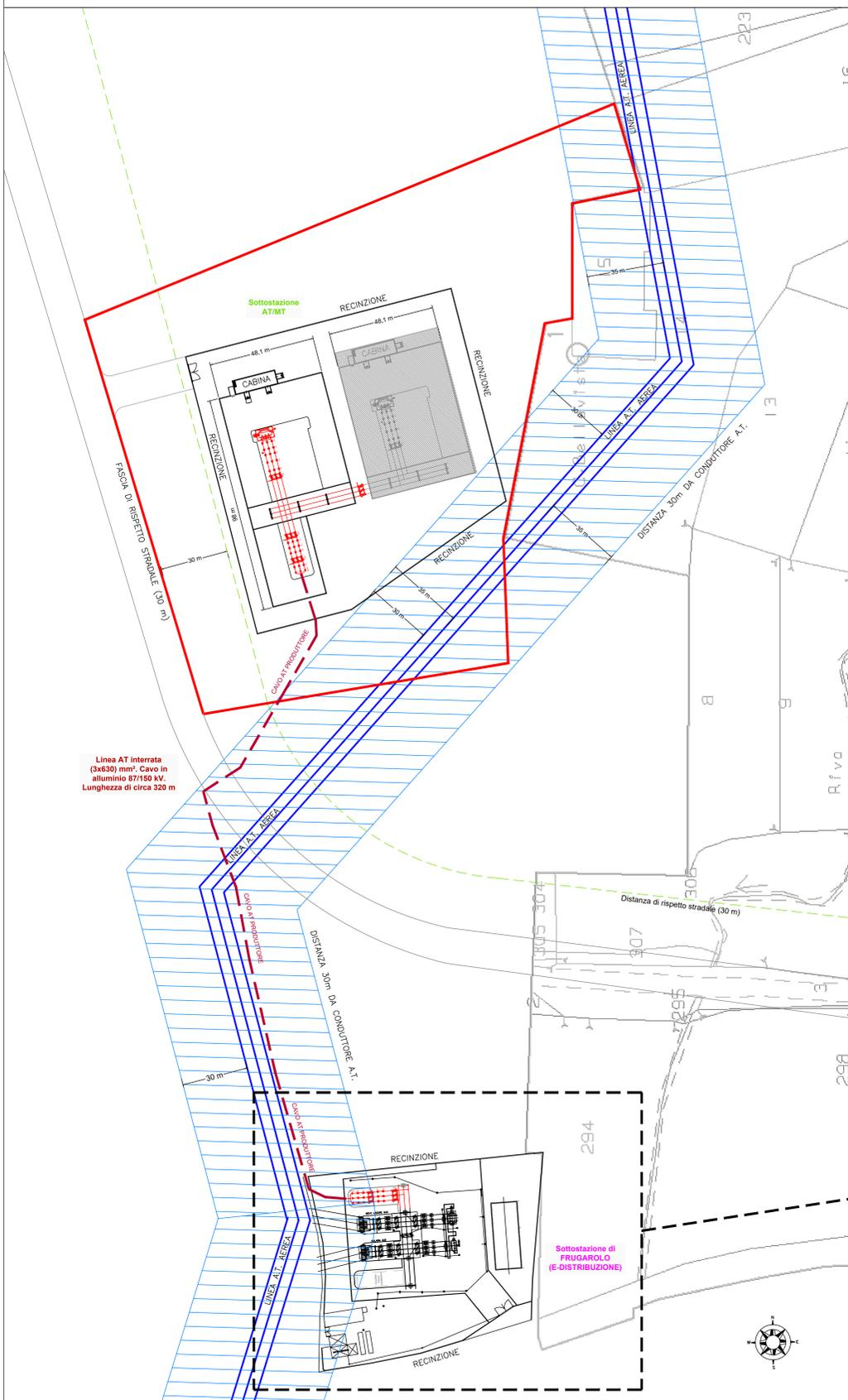
Linea AT interrata (3x630) mm². Cavo in alluminio 87/150 kV. Lunghezza di circa 320 m
