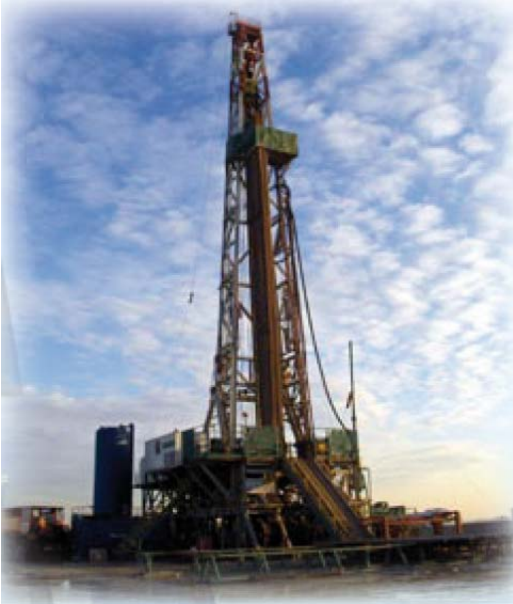
Fig. 3.2.3.1 – La torre di perforazione dell’impianto Ideco 1200 che sarà utilizzato per la perforazione del pozzo
