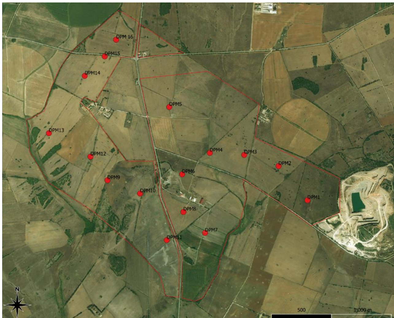
Figura 8-1 -Localizzazione prove penetrometriche
