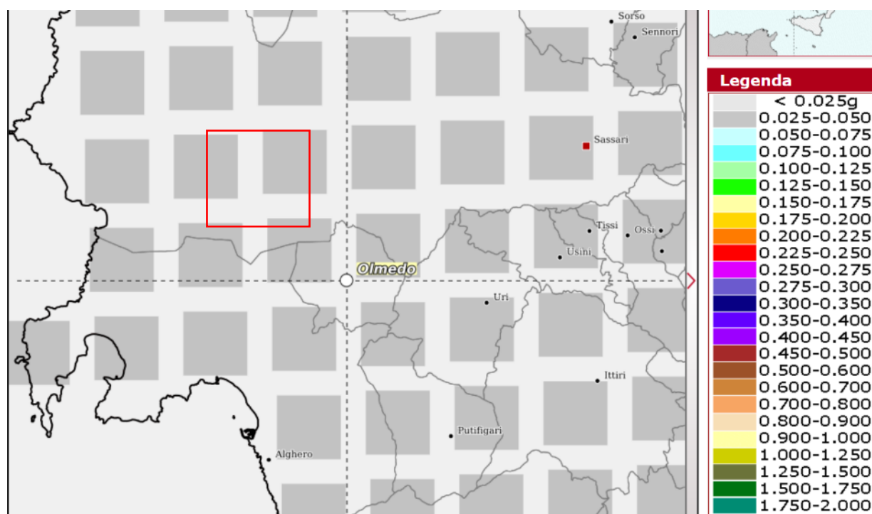
Figura 3-8 -Mappa di pericolosità sismica dell'area di studio(rettangolo rosso) riferimento Ordinanza PCM del 28 aprile 2006 n.3519, All.1b, espressa in termini di accelerazione massima del suolo con probabilità di eccedenza del 10% in 50 anni riferita a suoli rigidi ( V_s > 800 m/s; cat.A, punto 3.2.1 del 30 D.M. 14.09.2005)
