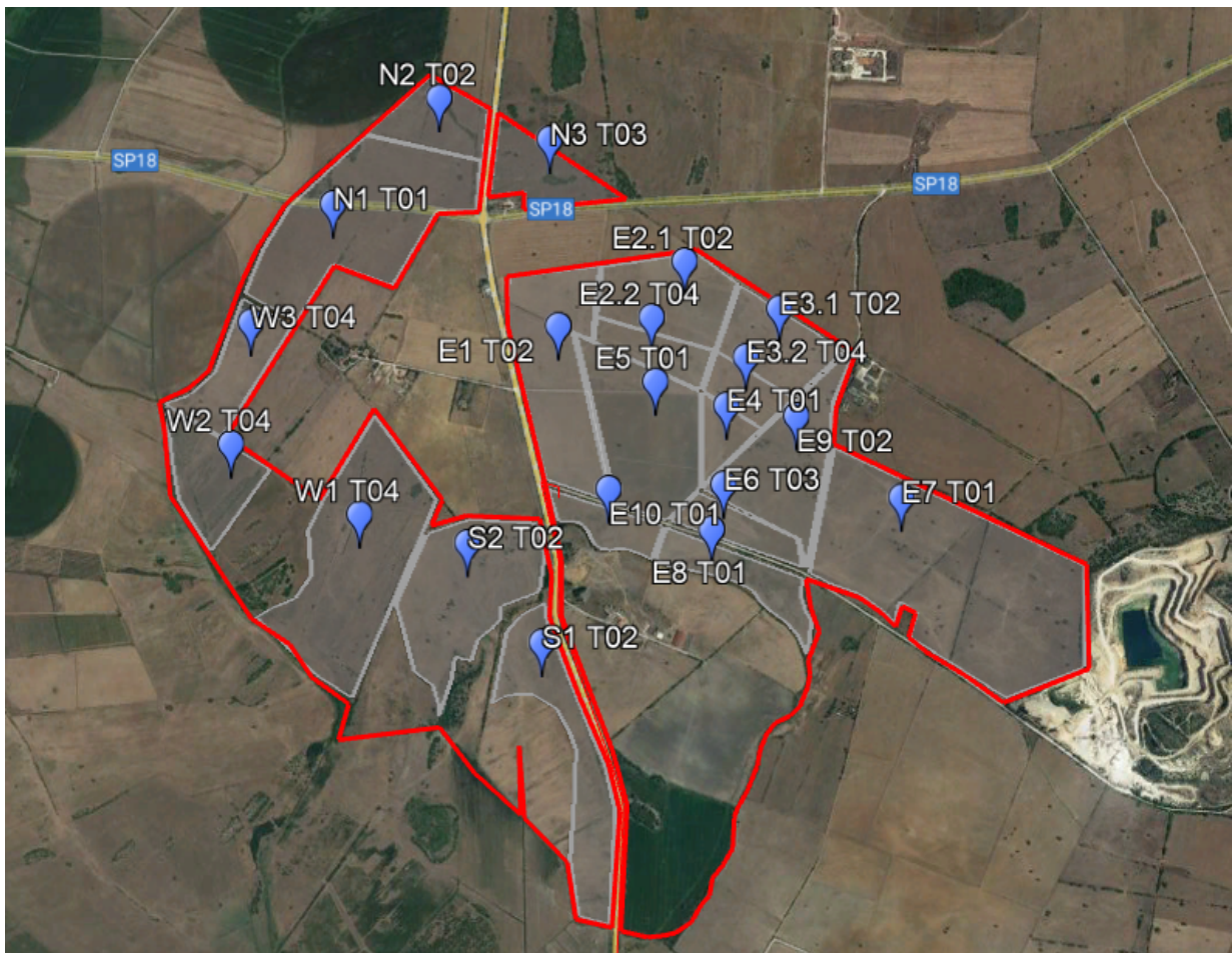
Figura 2-6 Suddivisione in lotti con relative strutture adottate
