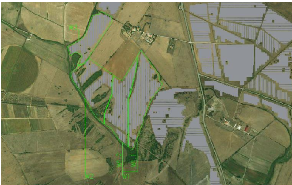
Figura 3-3 Suddivisione Impianto Fotovoltaico in sottocampi – Campo W
