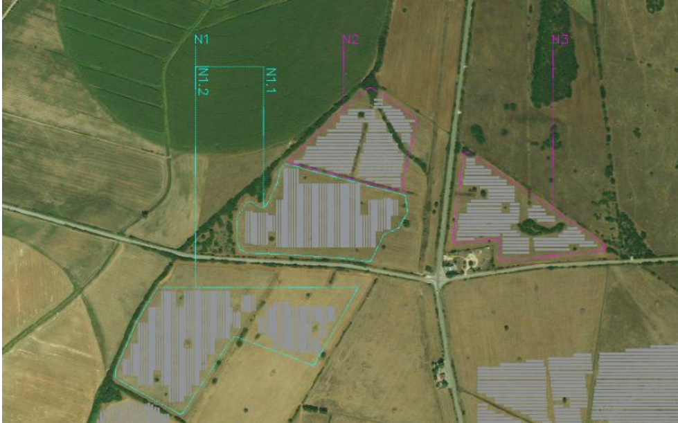
Figura 3-2 Suddivisione Impianto Fotovoltaico in sottocampi – Campo N
