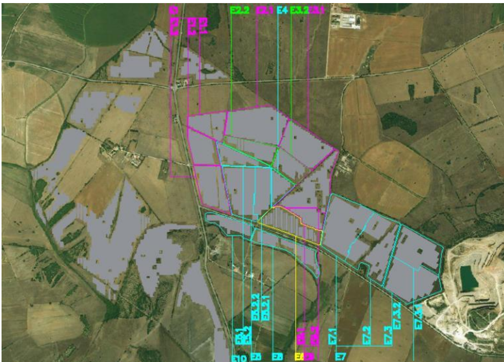
Figura 3-5 Suddivisione Impianto Fotovoltaico in sottocampi – Campo E
