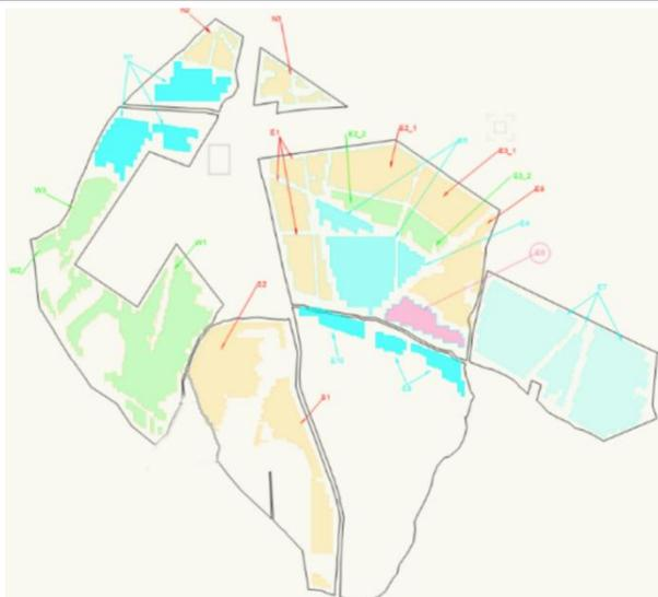
Figura 44 - mappa delle tipologie di strutture fotovoltaiche
