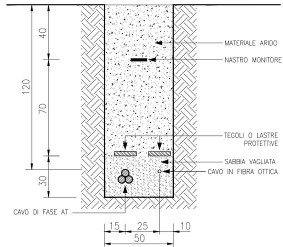
SEZIONE SCAVO CAVO AT SU STRADA ASFALTATA
