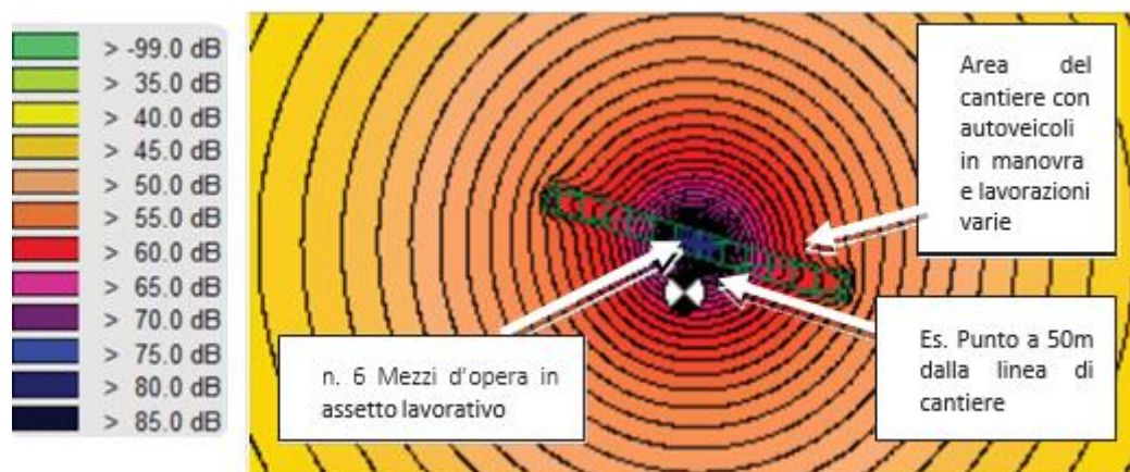
Figura 8-5: Rappresentazione grafica dell'emissione del cantiere – Curve di ISOLIVELLO dB(A)
