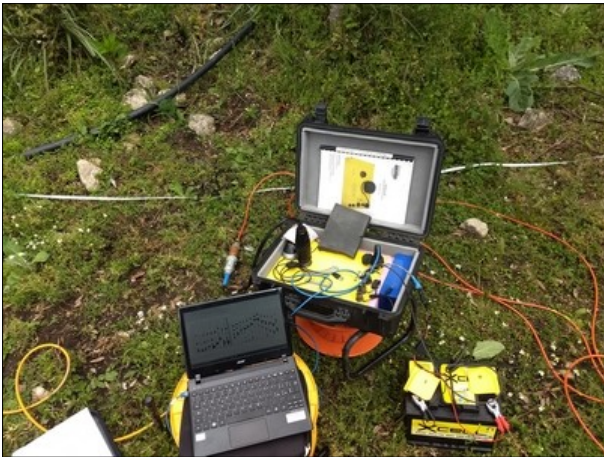
Fig. 2 - Sistema di ricezione e elaborazione – sistema di battuta onde P
