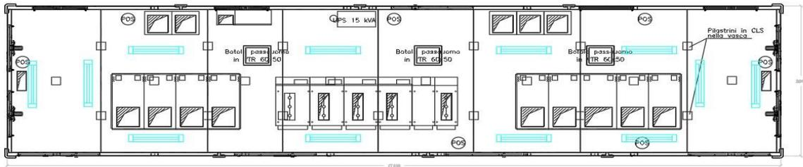
Figura 4.4 - Posizionamento plafoniere Cabina Power Station - cabina BT/MT.
