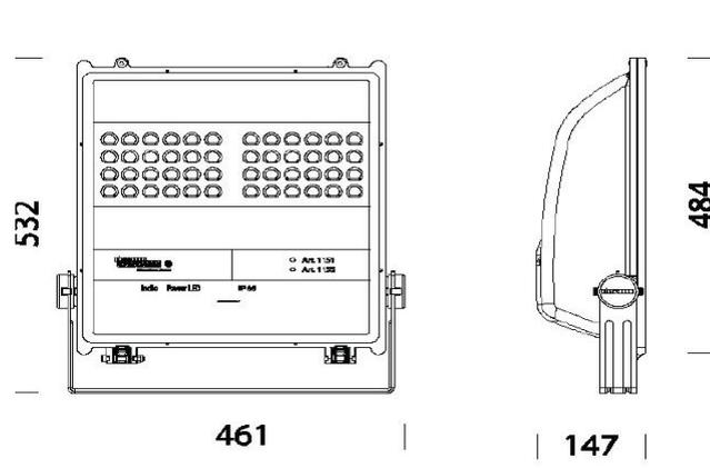
Figura 4.2: Dimensioni Indio Led con ottica asimmetrica
