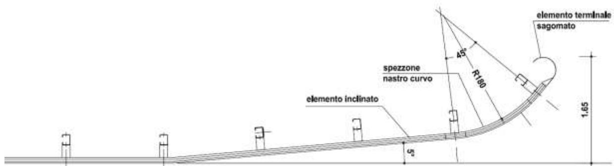
**figura 7.1: schema di blocco terminale di avvio**
