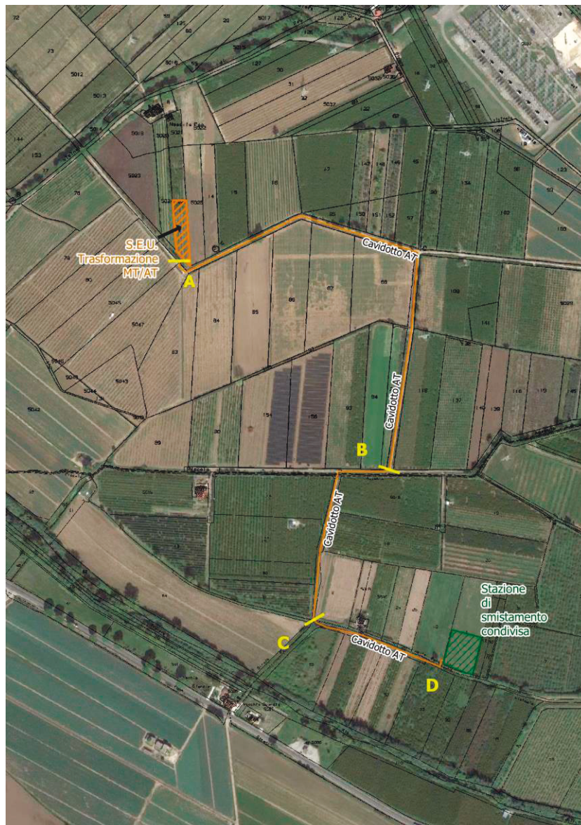
Figura 11 – Percorso Cavidotto MT
