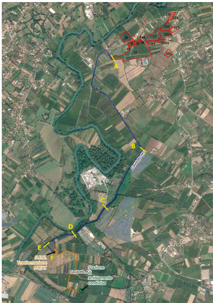
Figura 10 – Percorso Cavidotto MT
