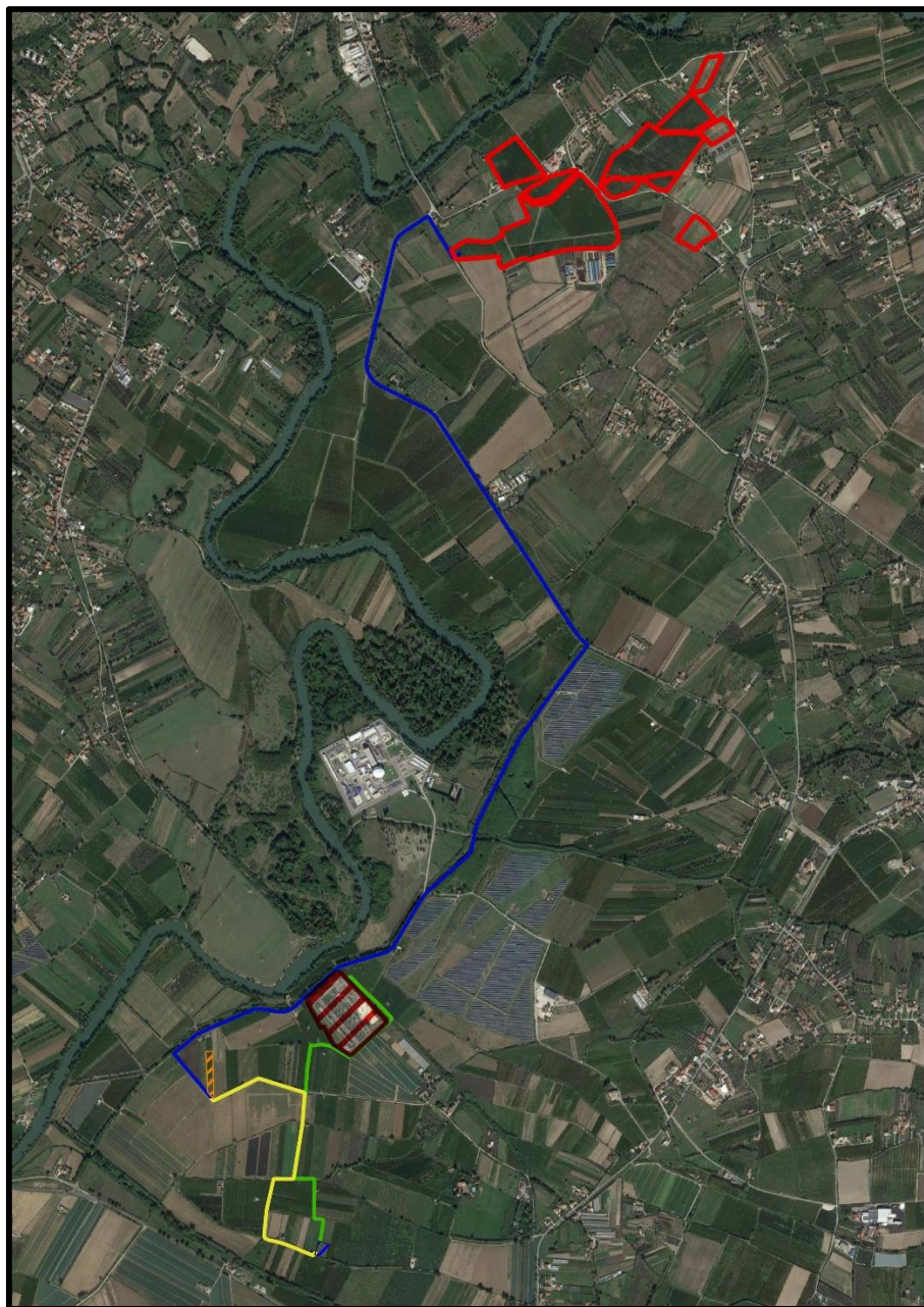
Fig. 54 - Immagine dell’intera area di intervento (Campo FV), Passaggio del Cavidotto, Cabina di Trasformazione MT/AT, e area della centrale elettrica TERNA.
