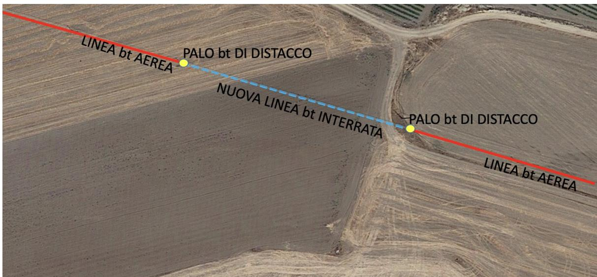
La sistemazione con interro della linea bt, consentirà di risolvere l'interferenza sia per l'impianto fotovoltaico, che per la linea di connessione dalla SSU alla SE RTN di Terna.
