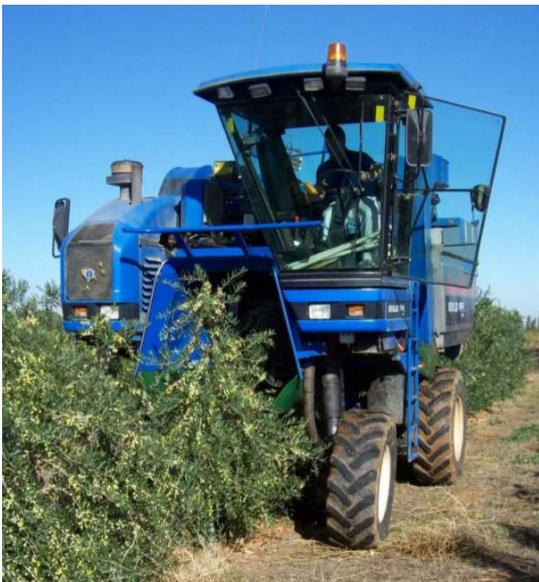
Fig.12: Macchina scavallatrice
