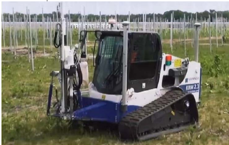
Figura 7. Esempio di fissaggio delle strutture di supporto
