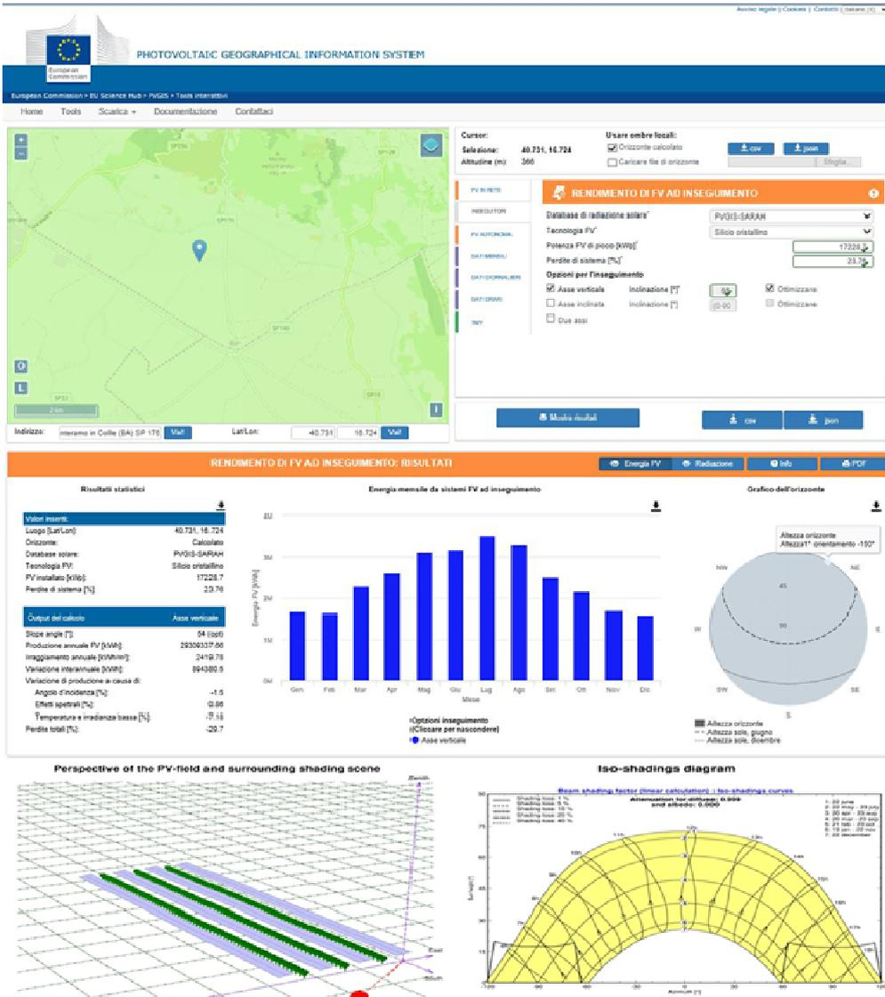
La producibilità di energia elettrica stimata al primo anno per il parco fotovoltaico in oggetto, di potenza attiva nominale pari a 15,576 MW e potenza di FV di picco di 17,228 MW è pari a circa 29,3 GWh/anno, con una producibilità unitaria di 1.701 kWh/kWp.
