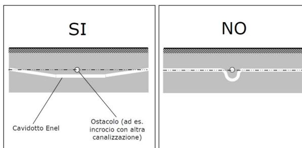
*Incrocio elettrodotta con altre linee elettriche interrate*
