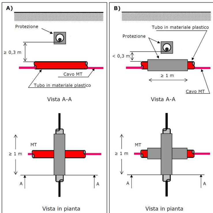
*Incrocio elettrodotto con altre linee elettriche interrate*
