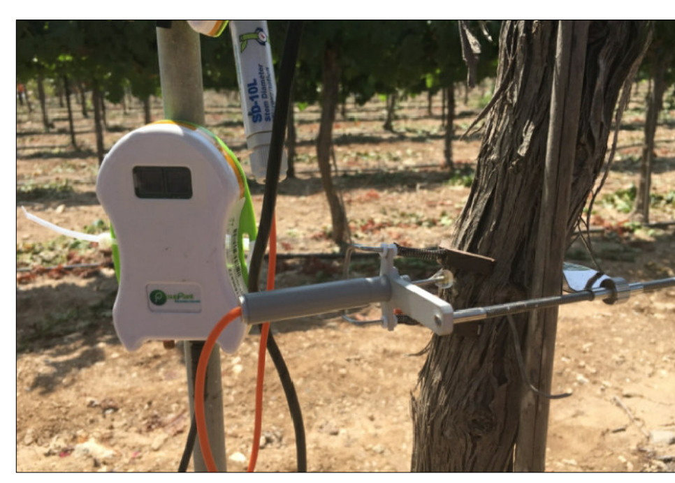
Sensore della crescita del tronco
