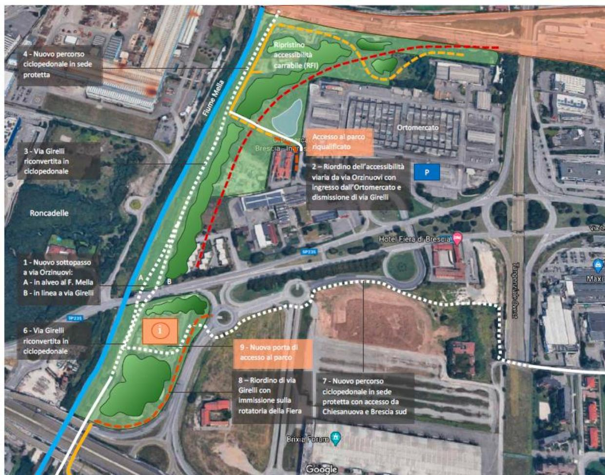
A completamento ed integrazione, al fine di garantire all'itinerario ciclabile e pedonale il ruolo di Greenway nel contesto del corridoio ecologico del Fiume Mella e del Plis delle Colline esteso al Mella, riveste particolare importanza il superamento della "barriera" costituita da via OrzINUOVI.
