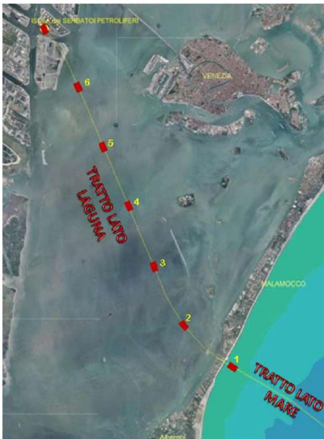
**Figura 3-15 Localizzazione delle isole artificiali per l'attraversamento mediante la tecnica della trivellazione orizzontale controllata.**
