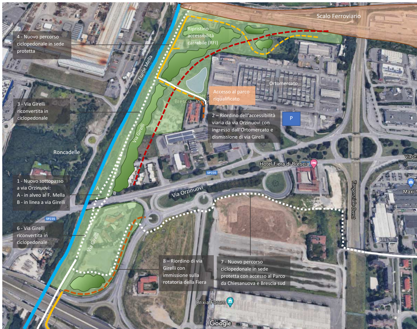
TAVOLA D – PROPOSTA DI RIASSETTO CICLOPEDONALE E VIARIO: FASE I - Completamento percorso ciclopedonale del Mella lungo via Girelli con separazione dalla viabilità locale e realizzazione del sottopasso di via Orzinuovi in alveo al Mella o in linea a via Girelli. Realizzazione della nuova connessione ciclopedonale per Chiesanuova e quartieri a sud della Città.
