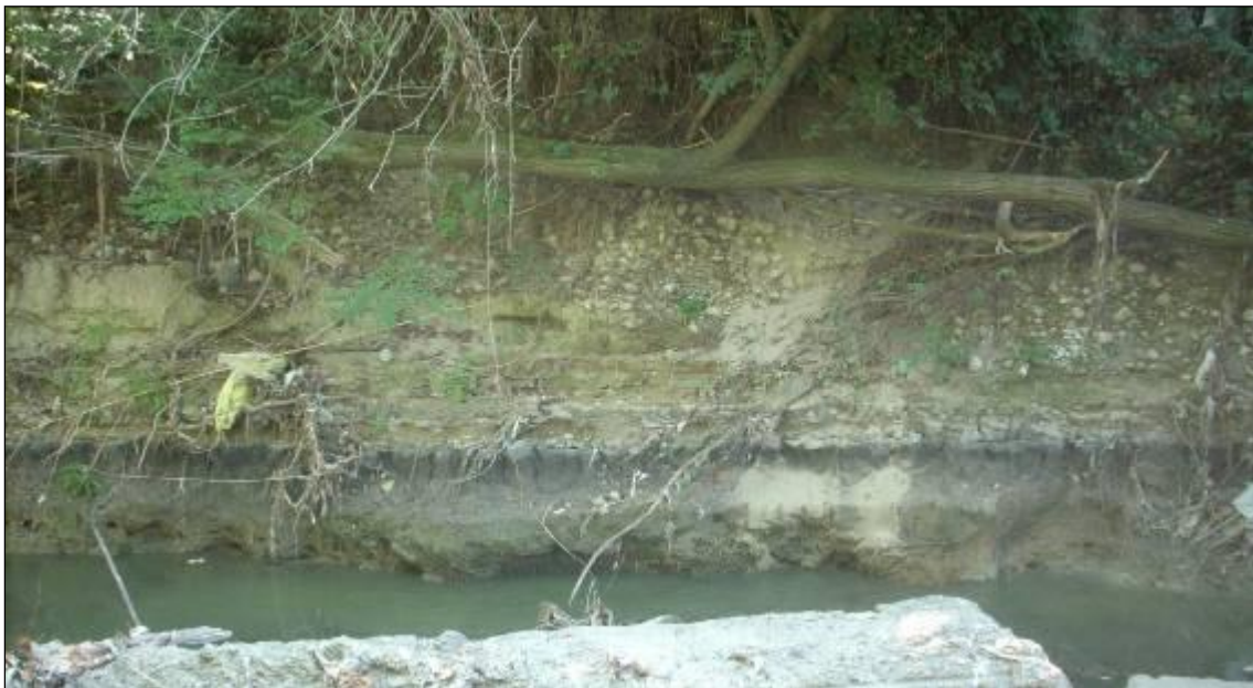
Figura 5-41 - Alveo del T. Savena: scarpata fluviale a geometria subverticale di altezza 3 m circa. Si noti il contatto stratigrafico tra depositi grossolani e terreni fini grigio scuro (località Fondo Mori).
