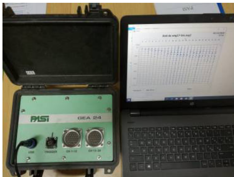
Sismografo Pasi GEA24
