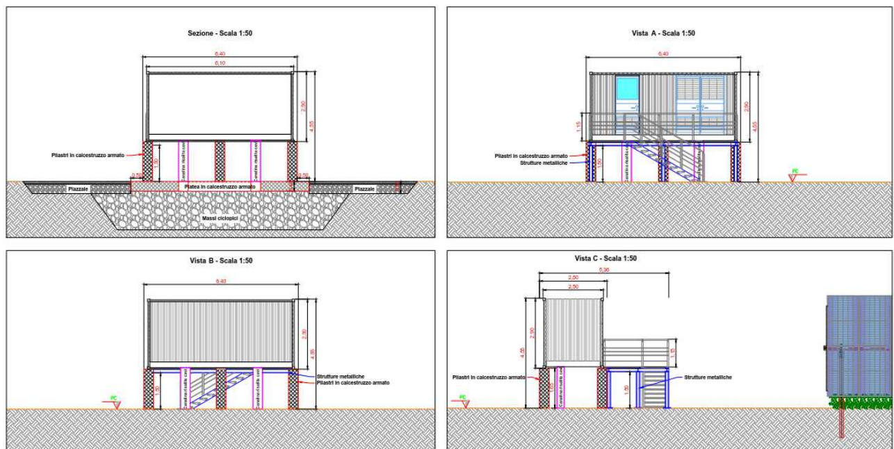
Figura 6-5: Estratto tavola 17b "Tipico cabina di raccolta MT sopraelevata".
