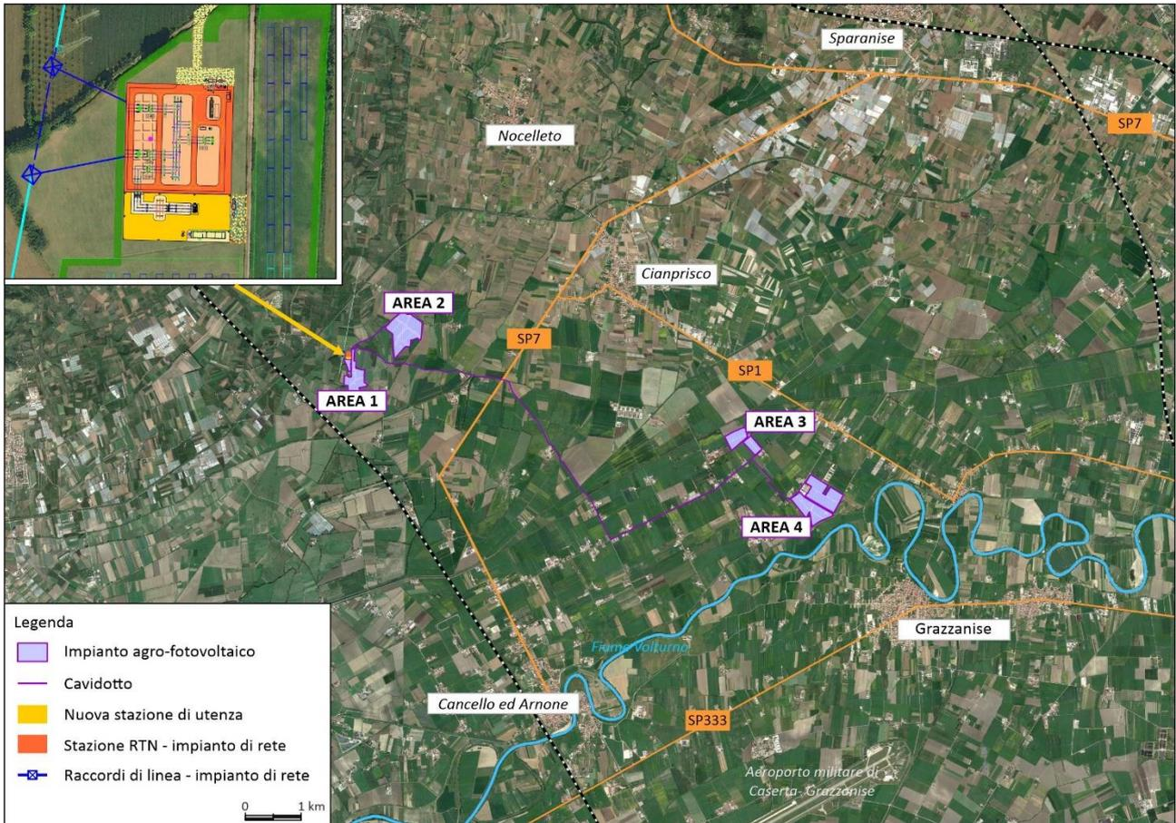
**Figura 1 - Lay out generale dell'impianto agro-fotovoltaico e delle opere connesse**
