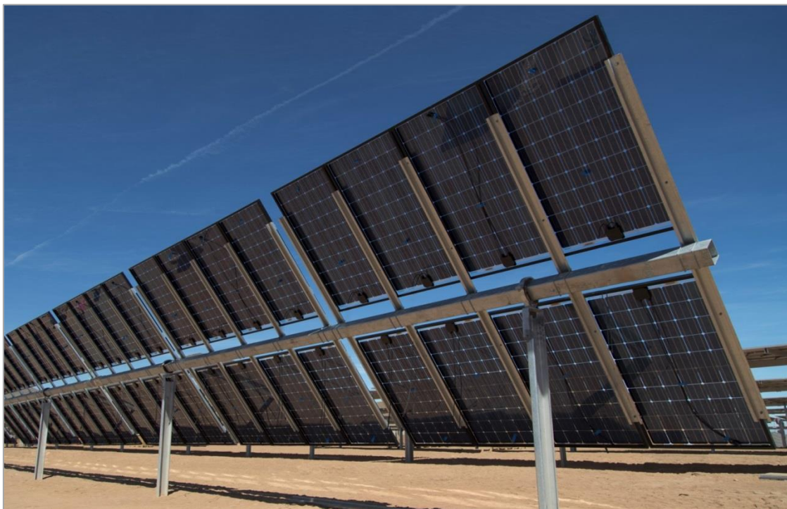
Figura III.5- Esempio struttura + modulo FV bifacciale
