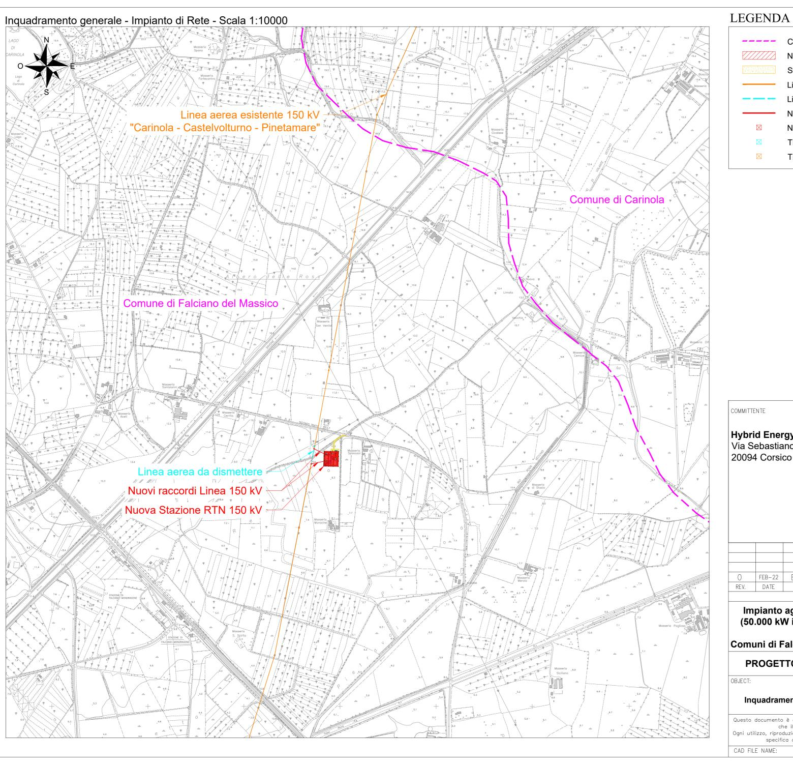
Confine comunale Nuova Stazione RTN 150 kV Strade e piazzali di nuova realizzazione Linea aerea esistente 150 kV "Carinola - Castelvolturno - Pinetamare" Linea aerea da dismettere Nuovi raccordi Linea 150 kV Nuovi tralicci Traliccio da dismettere Tralicci esistenti
