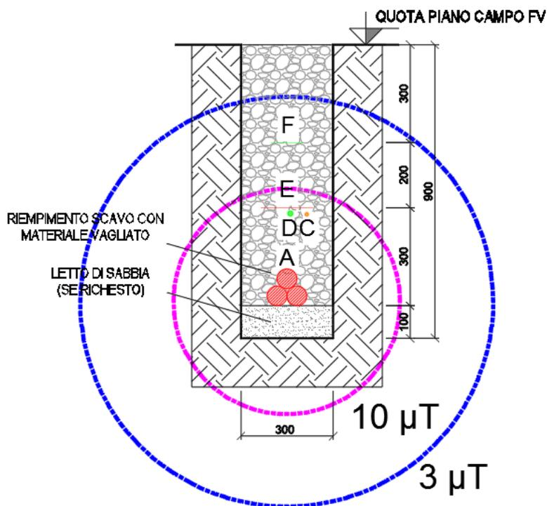
**Figura 6: Curve Equicampo - 1 Terna di cavi MT su strada sterrata - Interno Impianto FV**
