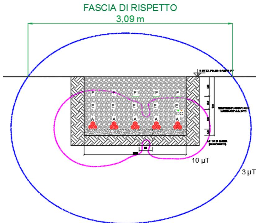
**Figura 10: Curve Equicampo - 5 Terne di cavi MT su strada sterrata - Interno Impianto FV**
