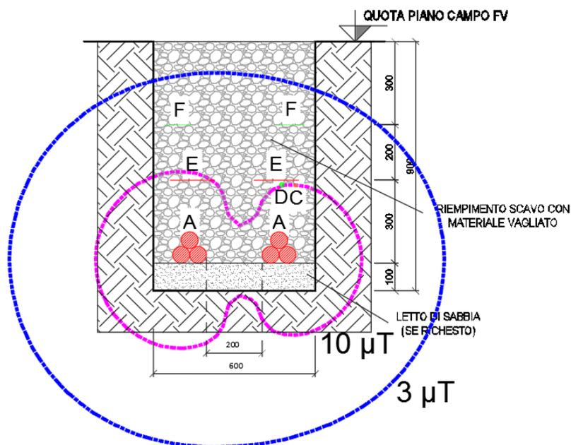
**Figura 5: Curve Equicampo - 2 Terne di cavi MT su strada sterrata - Interno Impianto FV**
