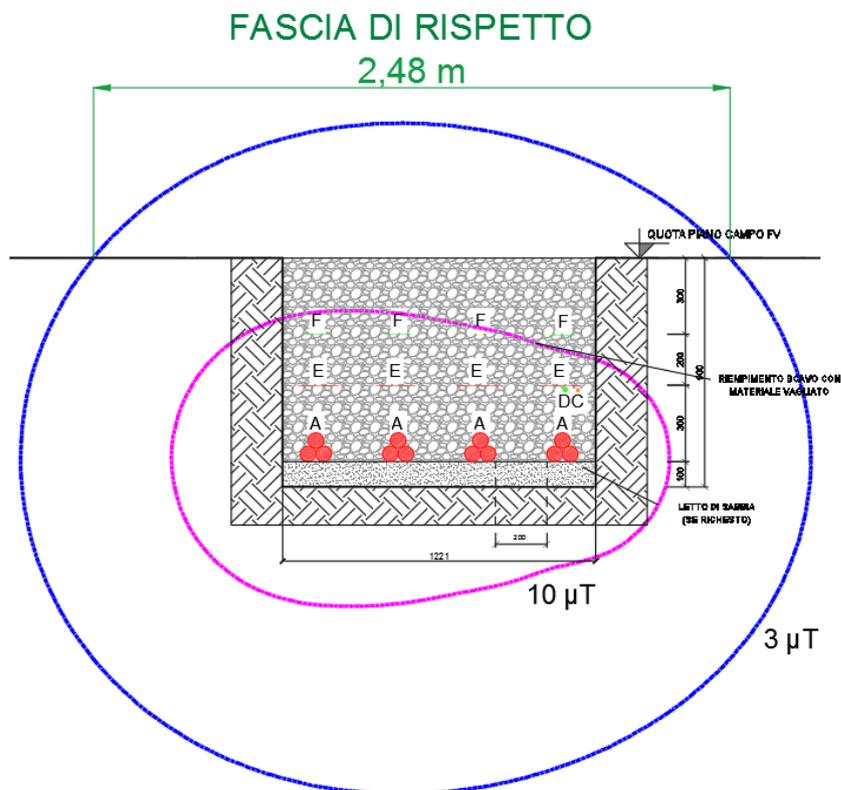
Figura 9: Curve Equicampo - 4 Terne di cavi MT su strada sterrata - Interno Impianto FV
