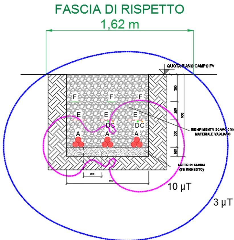
**Figura 7: Curve Equicampo - 3 Terne di cavi MT su strada sterrata - Interno Impianto FV**
