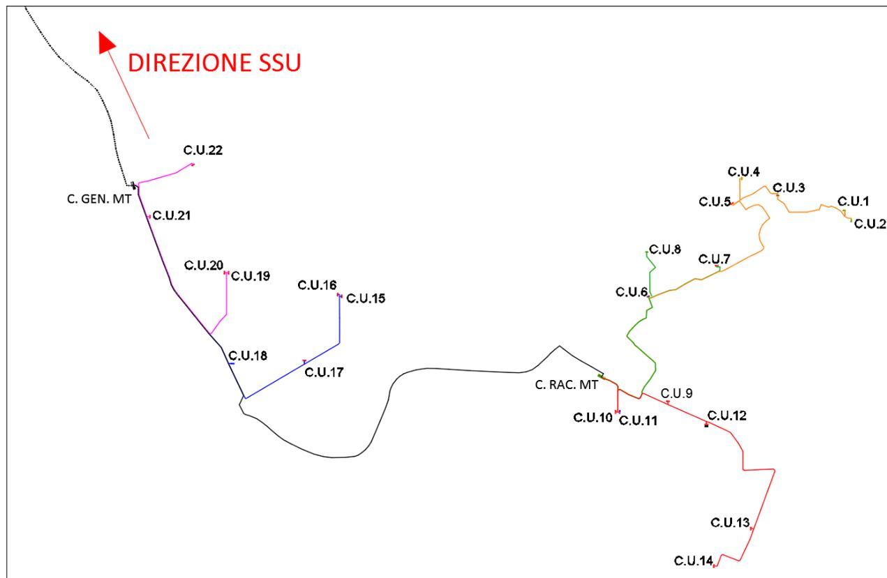
**Figura 2: Layout Cavi MT interno impianto FV**
