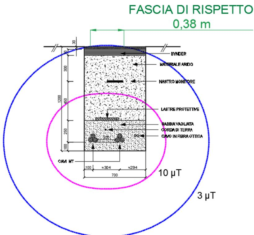
**Figura 8: Curve Equicampo - 2 Terne di cavi MT su strada asfaltata - Interno Impianto FV - Connessione Aree Impianto FV**
