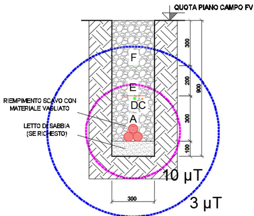
Figura 4: Curve Equicampo - 1 Terna di cavi MT su strada sterrata - Interno Impianto FV
