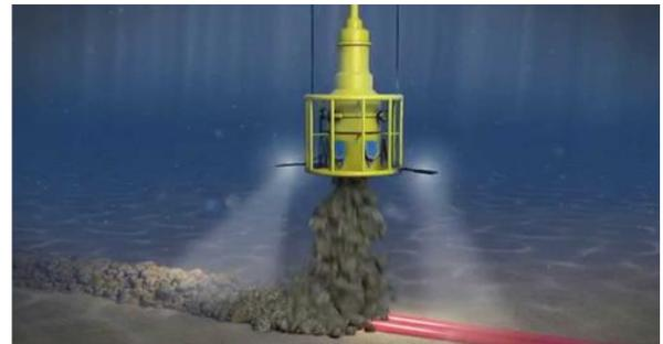
**Figura 6.12 – Protezione del cavidotto marino mediante massi.**
