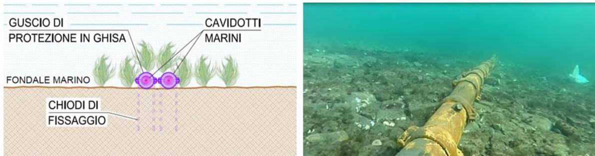
**Figura 6.14 – Protezione del cavidotto marino mediante gusci in ghisa.**
