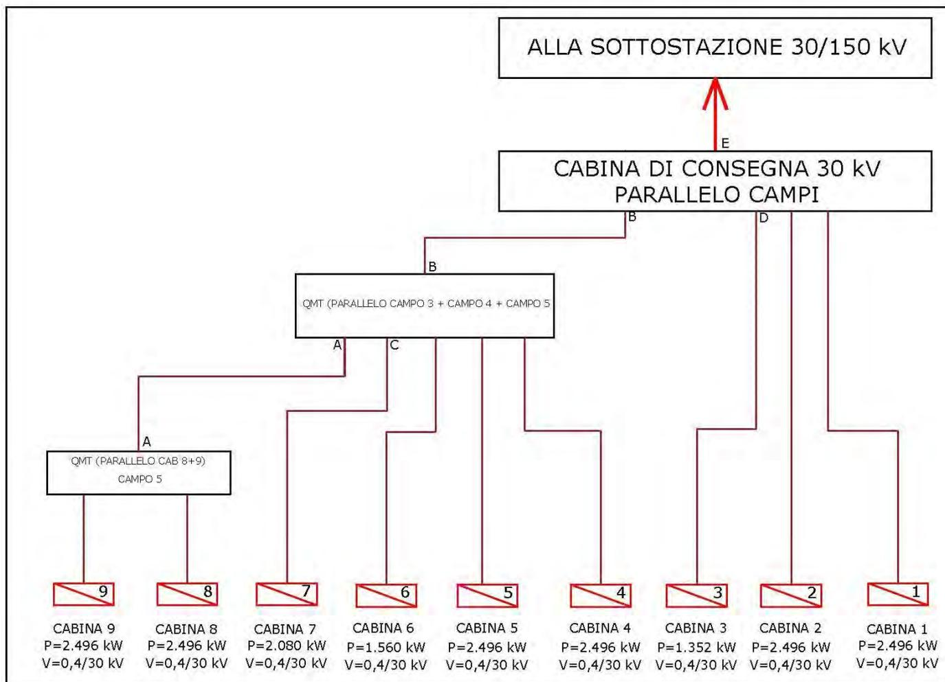
La scelta progettuale è stata quella di ottimizzare le fasi installative e ridurre al minimo gli impatti sul territorio, per cui le cabine di campo saranno realizzate mediante box o cabine prefabbricate, nel quale saranno alloggiati le apparecchiature elettriche.
