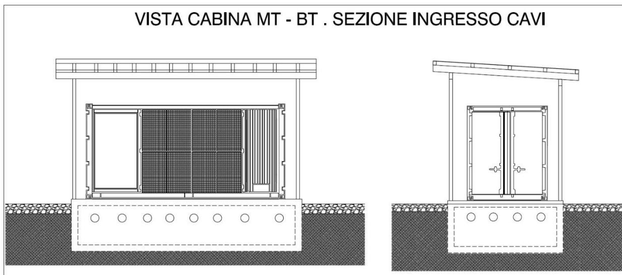
La connessione alla rete elettrica è prevista tramite linea interrata, da ciascuna sezione di impianto attraverso il collegamento di ciascuna cabina di trasformazione, fino alla cabina di consegna sita in prossimità dell'accesso al campo; la tensione di lavoro sarà pari a 30kV, in modo da ridurre le perdite lungo il tracciato.
