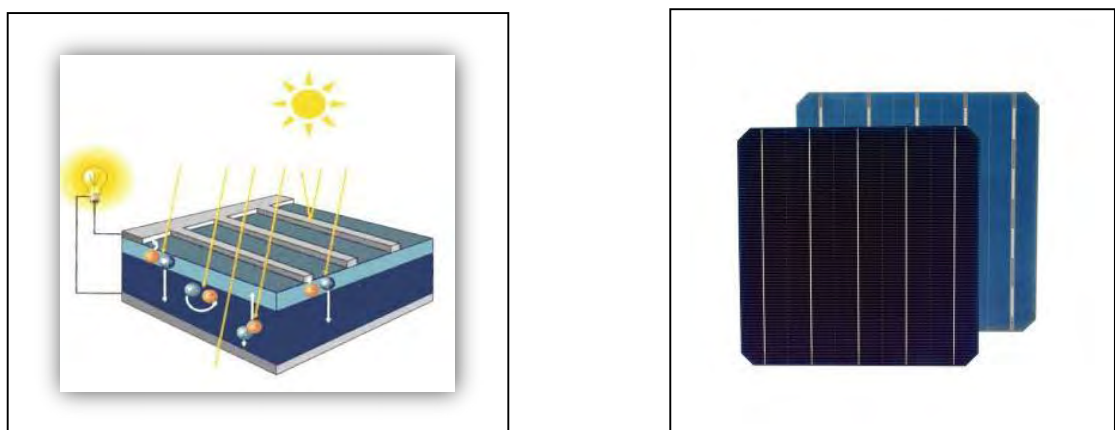
Figura 1 – Schema di funzionamento e foto di una cella fotovoltaica con 5 busbarr
