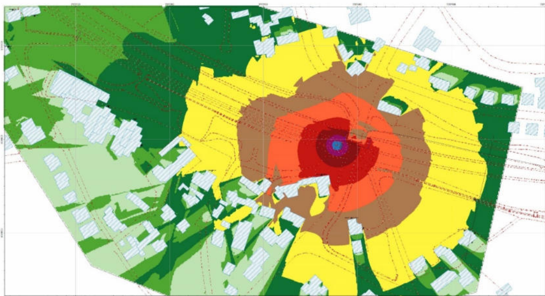
Infissione Palancole - h 30 m (assoluta) – Isofoniche
