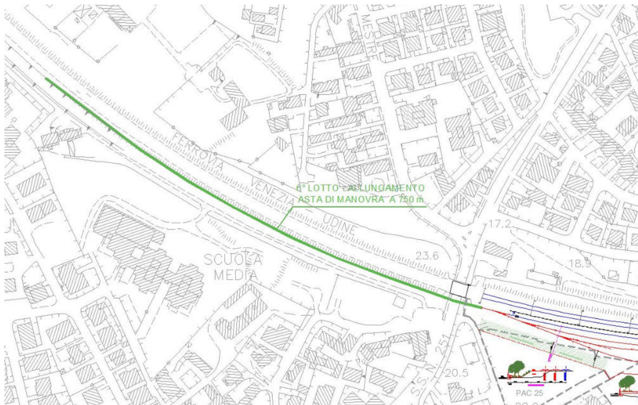
Area di cantiere allungamento asta di manovra, compreso l'intervento di allargamento del sottopasso
