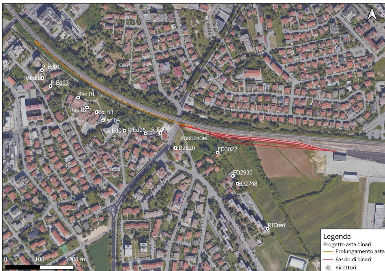
Fig. 24 Inquadramento degli interventi di lavorazione e individuazione dei recettori (Fonte: ns. elaborazione mediante Qgis).
