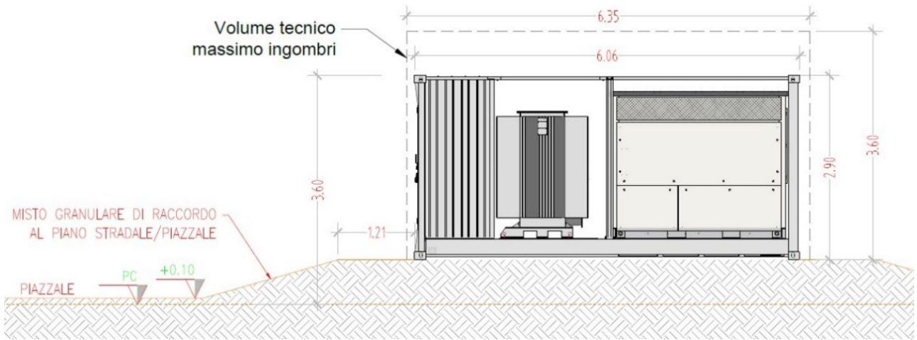
Tipologico ingombro prospetto frontale Cabina Inverter
