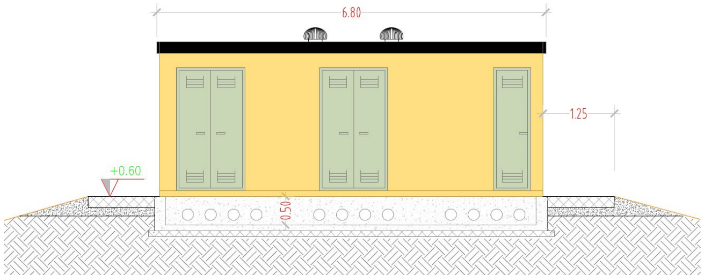
Particolare Prospetto Frontale Cabina Ausiliaria
