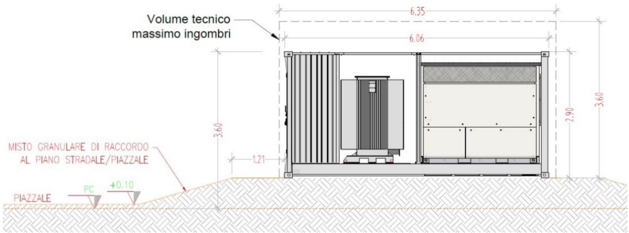
Tipologico ingombro prospetto frontale Cabina Inverter
