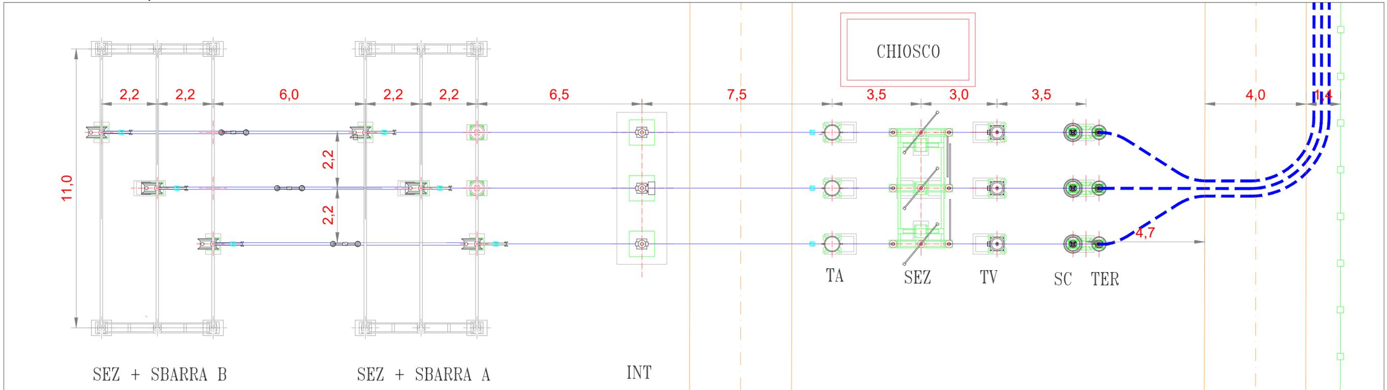
Sezione longitudinale stallo produttore 150 kV - Scala 1:100
