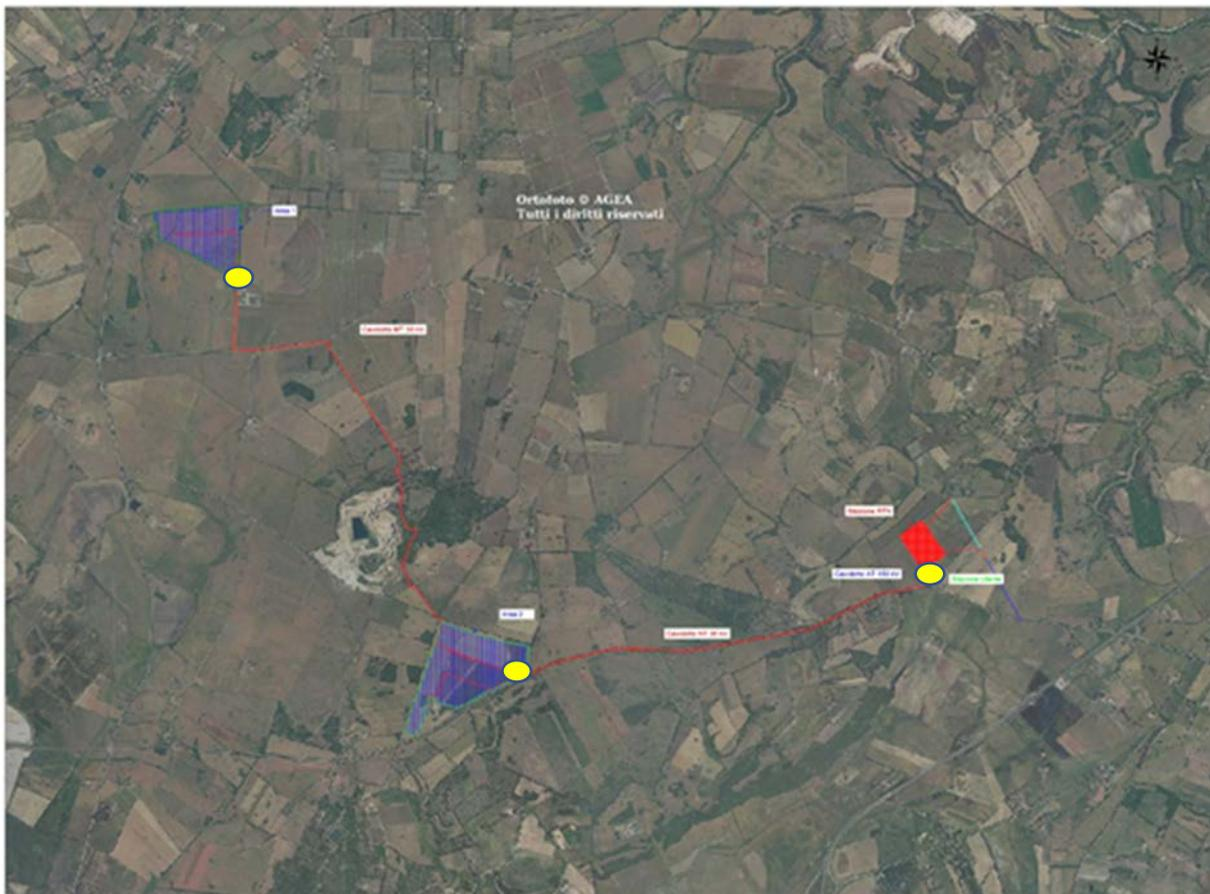
Figura 10 - Individuazione dei punti di misura delle vibrazioni
