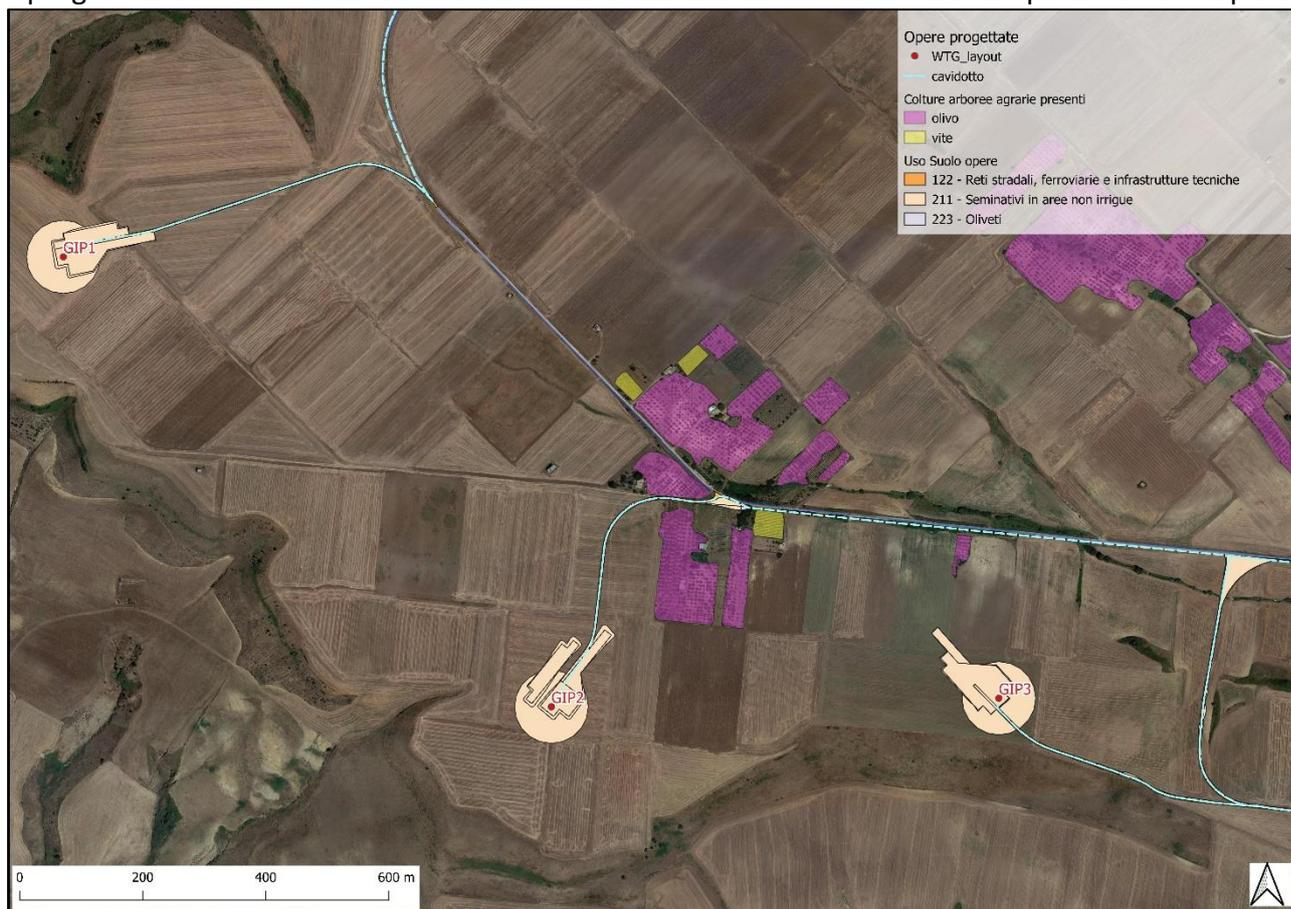
Figura 15 – Particolare della classificazione di suo del suolo, come da CTR, per gli aerogeneratori 1, 2 e 3.
