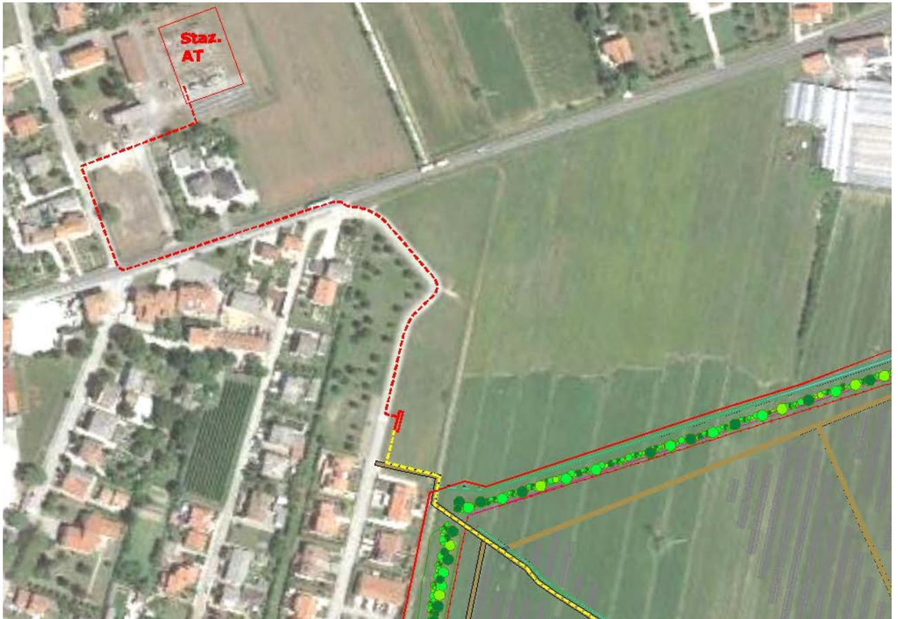
*Figura 5.1. Posizionamento Cabina di Connessione – alternativa B*
