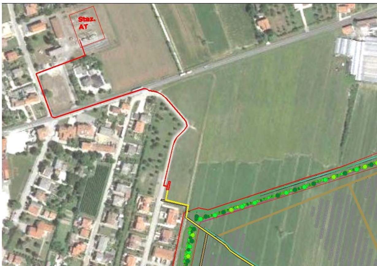
*Figura 5 Posizionamento Cabina di Connessione – alternativa A*
