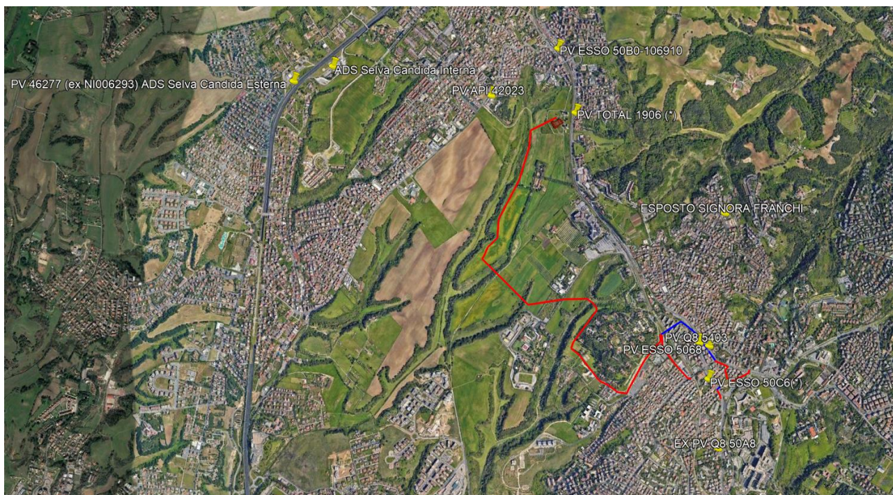
Figura 9-2 Localizzazione generale siti contaminati (in giallo) rispetto al tracciato di progetto (in rosso-scavo a cielo aperto, in blu scavo con microtunnelling)
