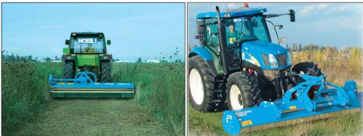
Esempi di trincia posteriore e anteriore di notevole larghezza
