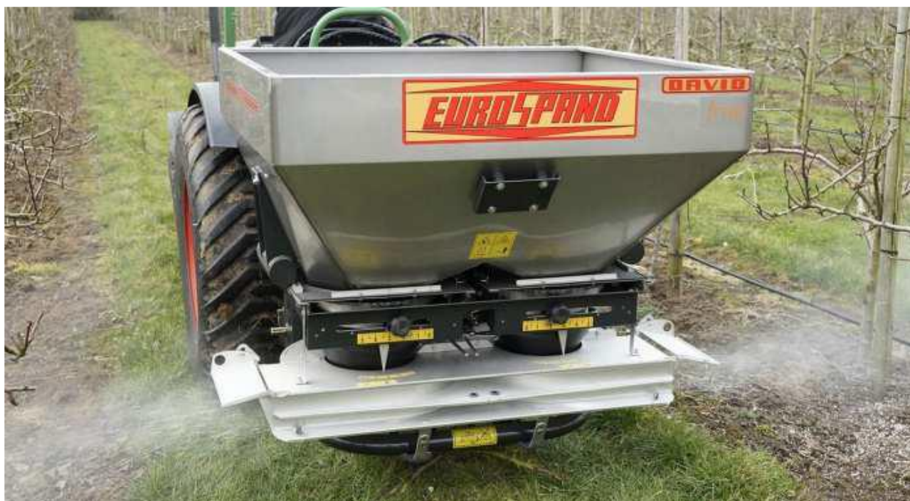
esempio di spandiconcime localizzato mono/bilaterale per frutteti
